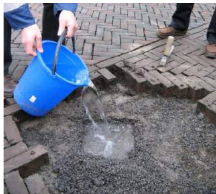
Waterdoorlatend wegoopbouw - Foto: Aquaflow
