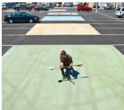
Lichte verharding die het zonlicht reflecteert en opwarming reduceert - Bron: Lawrence Berkeley National Laboratory
