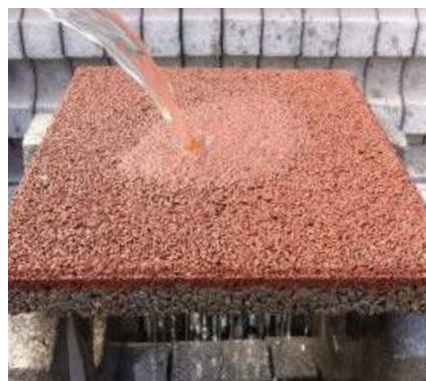
Poreuze tegels op laagste punt in de straat - Bron: NOYA
