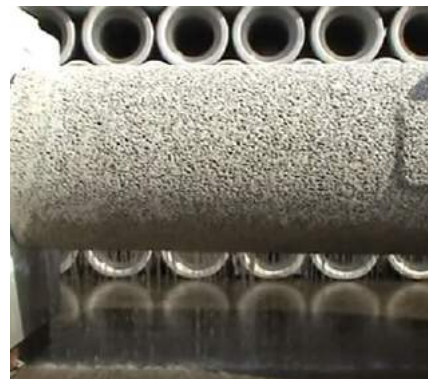
Infiltratiebuis geproduceerd met openstructuur beton - Bron: Eurodrain van Streek Beton
